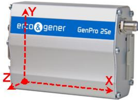
Figure 24 : Positionnement des axes de l'accéléromètre
